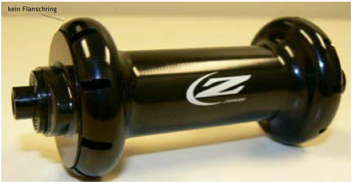
Bild 4: Spätere Version der ZIPP 88v9 Vorderrad-Nabe – nicht-betroffene Version
